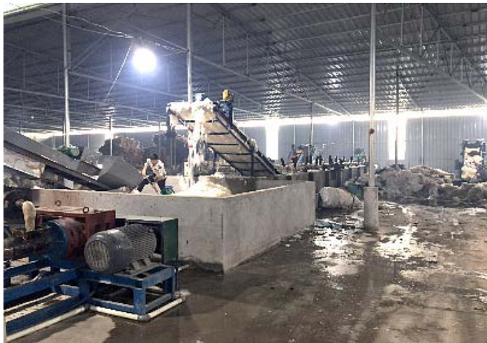
全長20mほどのラインで洗浄からペレット化まで行っており、3本のラインが稼働していた。
