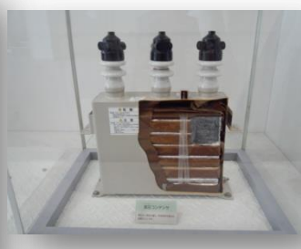
高濃度 PCB を含む高圧トランス高圧コンデンサ等
