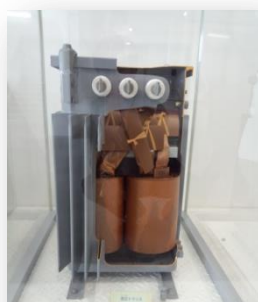
高濃度 PCB を含む高圧トランス高圧コンデンサ等
